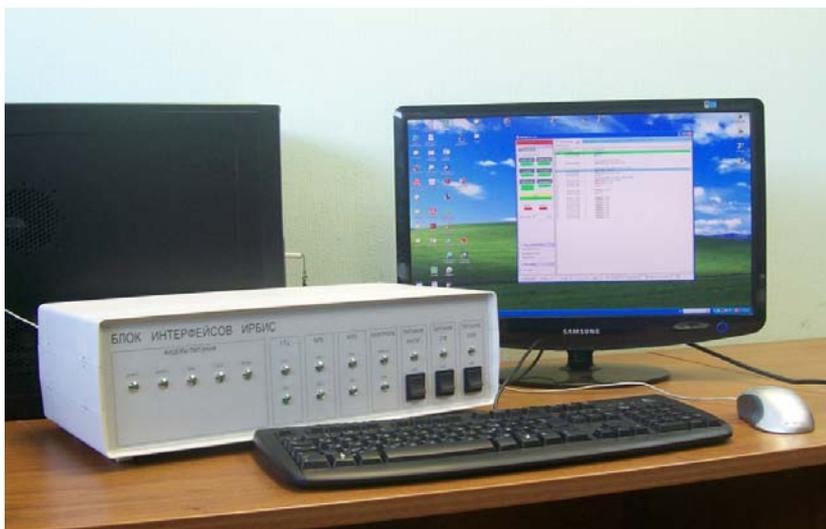
Рисунок 3 – Имитатор космического аппарата - ИРБИС
