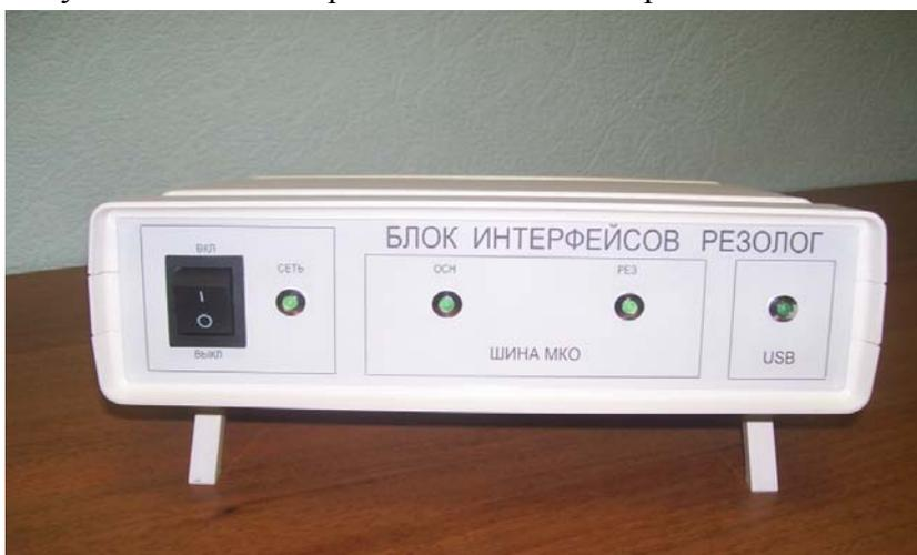
Рисунок 4 - Блок интерфейсов монитора шины МПИ КА проекта РЕЗОНАНС
