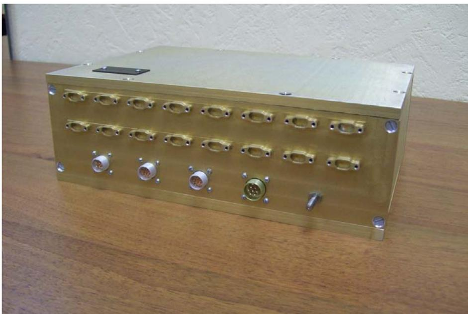
**Рисунок 1 – Внешний вид теплового эквивалента бортового маршрутизатора**
