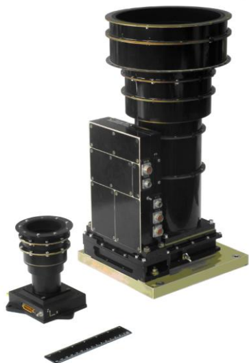
Рис. 1. Фото приборов звездной ориентации (справа БОКЗ-М60/1000, слева прибор МикроБОКЗ на КМОП-матрице
