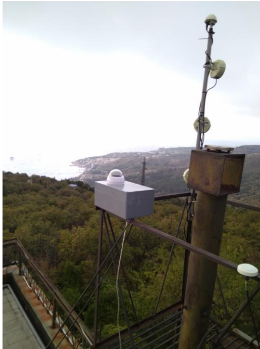
Рисунок 3. Камера для мониторинга неба в районе зенита на обсерватории КраО в п.Симеиз.
