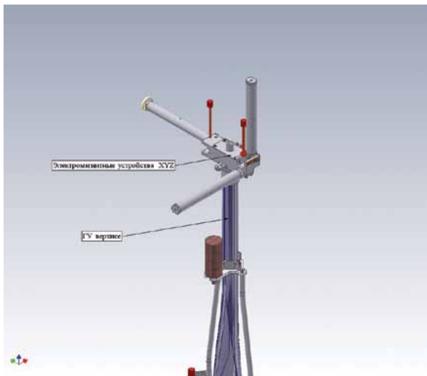
Рис.16. Компоновка ЭМУ на верхней гравитационной штанге (ГУ)
