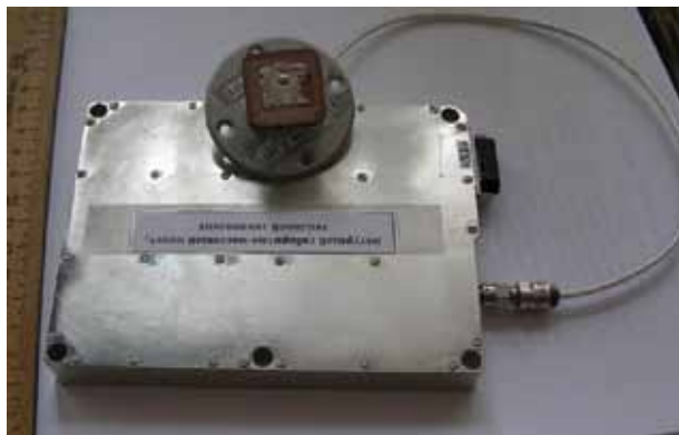
Рис.5. Бортовой комплект передатчик/антенна для микроспутника «Чибис-М»
