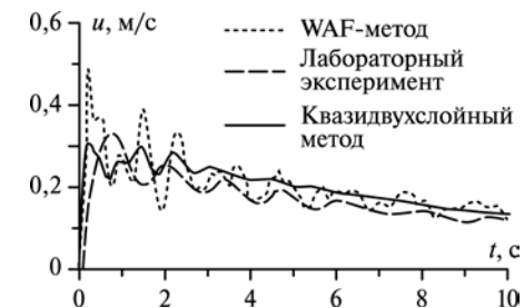
Рис. 2.32. Зависимость скорости жидкости в направлении x от времени в точке P5
