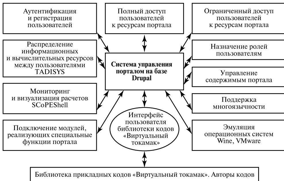
Рис. 1. Структура информационно-вычислительного портала «Виртуальный токамак». Стрелками показаны основные информационные потоки
