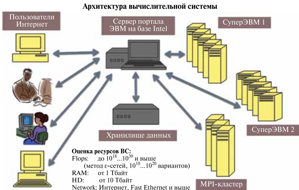
Рис. 3. Архитектура вычислительной системы комплекса «Виртуальный токамак»
