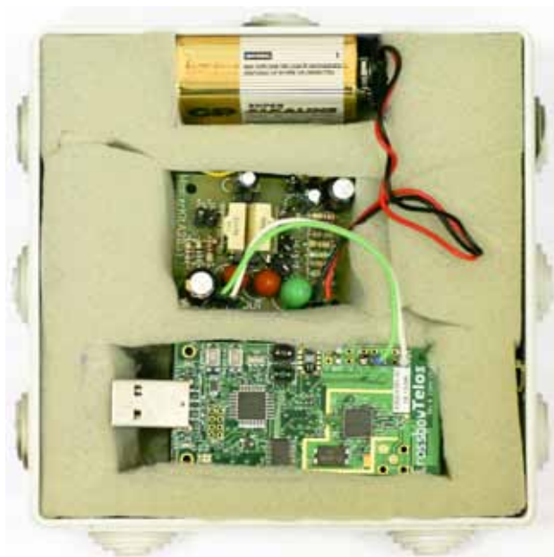
Рис. 3. Платформа TelosB, оснащенная инфразвуковым сенсором
