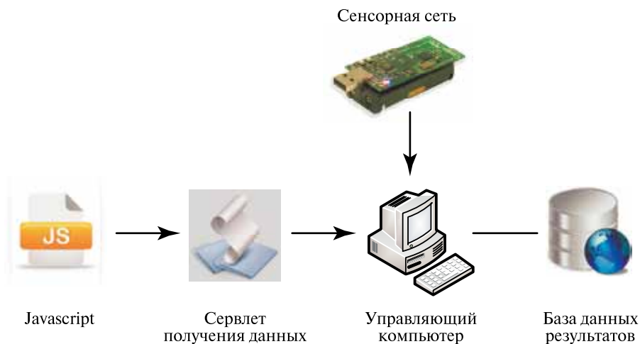
Рис. 14. Общая схема работы системы визуализации временных рядов
