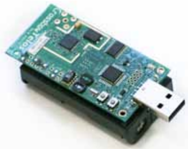
Рис. 1. Внешний вид модуля беспроводной сенсорной сети TelosB
