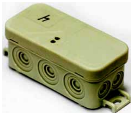
Рис. 12. Внешний вид защитной оболочки мота с проделанными отверстиями для сенсоров измерения освещенности
