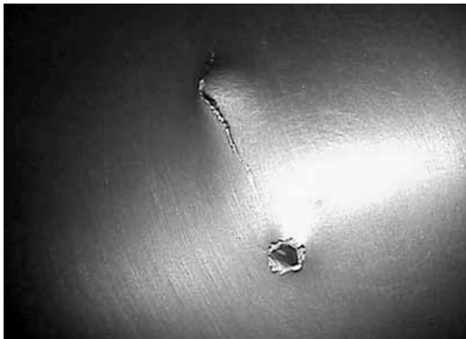
Рис. 3.1.24. Пробоина и трещина на панели радиатора шаттла миссии STS-115
