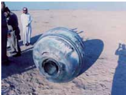
Рис. 3.1.4. 70-килограммовый главный титановый кожух твердотопливного двигателя верхней ступени РН «Дельта», найденный в 240 км от Эль-Рияда [РАМ-D Debris..., 2001]
