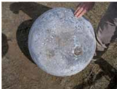
Рис. 3.1.6. Баллон для сжатого газа РН «Зенит», найденный в штате Колорадо в марте 2011 г.
