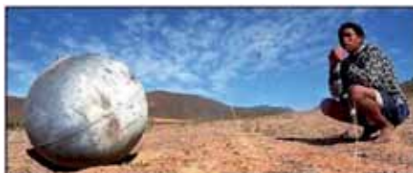
Рис. 3.1.4. 70-килограммовый главный титановый кожух твердотопливного двигателя верхней ступени РН «Дельта», найденный в 240 км от Эль-Рияда [РАМ-D Debris..., 2001]
