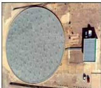
Рис. 1.2.6. Приемная антенна РЛС GRAVES (вид с воздуха)
