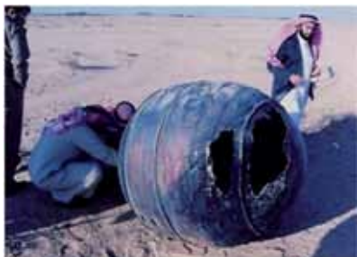
Рис. 3.1.3. Фрагмент 3-й ступени РН «Дельта» (56 кг, Саудовская Аравия, 2001 г.)
