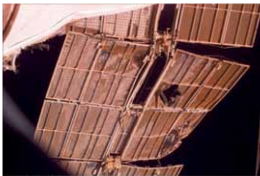
Рис. 3.1.9. Сильные повреждения солнечных панелей модуля «Спектр» ОС «Мир», полученные в июне 1997 г.
