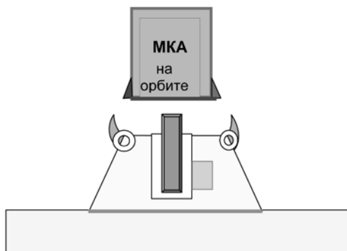
Рис. 1. Структурная схема ААС (а), конструктивная схема ААС до (б) и после (в) отделения МКА от ракеты-носителя
