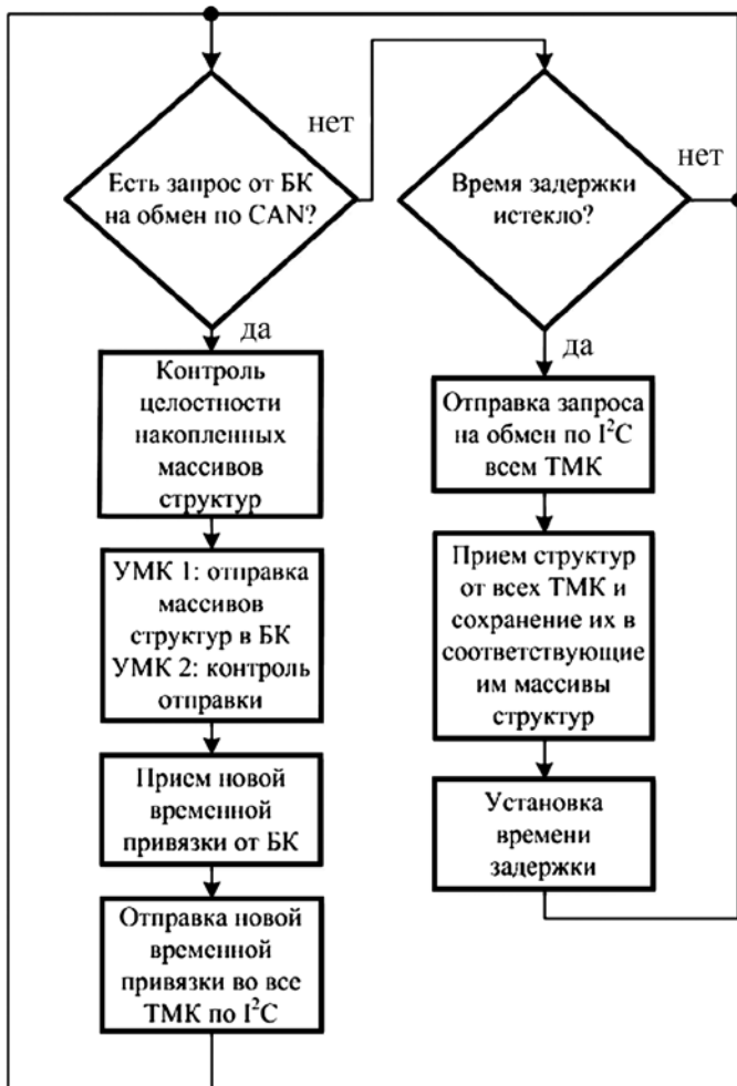
Рис 6. Алгоритм работы управляющего микроконтроллера
