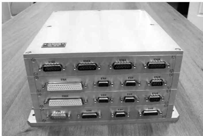
Рис. 2. Бортовой комплекс управления (БКУСНИ) на основе рамочной конструкции
