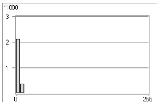
Рис. 7. Спектр яркости пикселей трековой области за 33 мс до прохождения ионизирующей частицы
