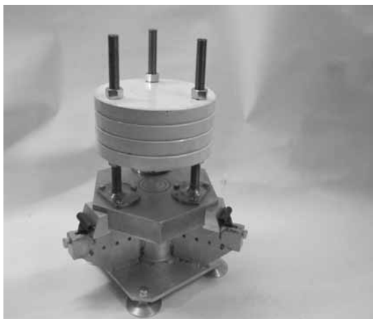
Рис. 2. Макетный вариант адаптивной системы для механических испытаний микроспутников различных масс
