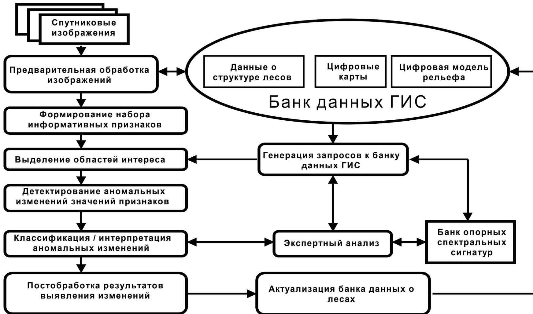
Рис. 8 Логическая схема выявления изменений в лесах с использованием спутниковых изображений
