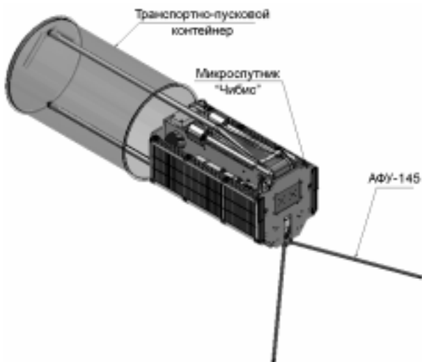
Рис. 2. Расчеховка и развертывание двух гравитационных устройств (ленточных штанг) системы ориентации спутника СОС ГУ приводит к выталкиванию микроспутника «Чибис» из транспортно-пускового контейнера
