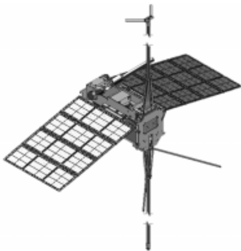
Рис. 5. Гравитационные устройства СОС ГУ автоматически разворачиваются на 90^\circ , образуя «гравитационную гантель». Автоматически разворачиваются датчики магнитно-волнового комплекса
