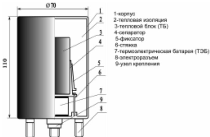
Рис. 3. Конструктивная схема РИТЭГ «Арес»
