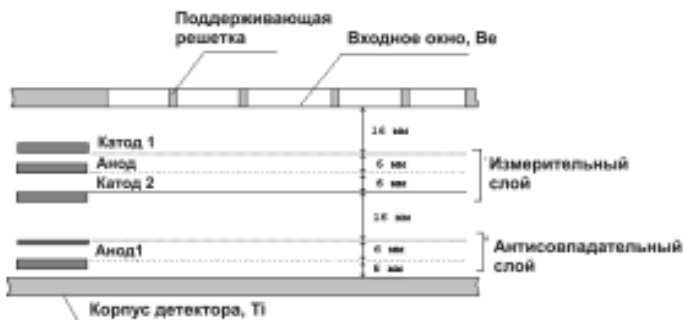
Рис. 5. Схема многопроволочной пропорциональной позиционно-чувствительной камеры
